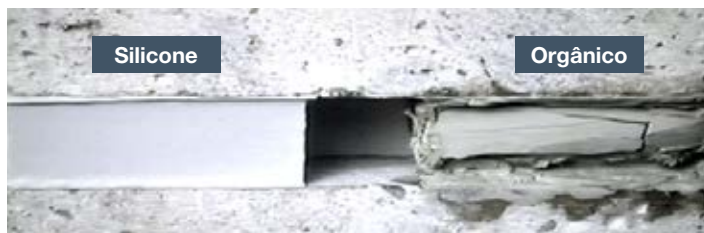
Resultado de teste com aplicação de selante de silicone e selante orgânico (poliuretano) após 2.500 horas de exposição aos raios UV artificiais em laboratório.
