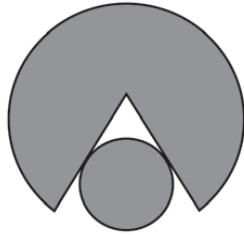
図 4: 「ホットドック法」によるバックアップ材ロッドの拡張
