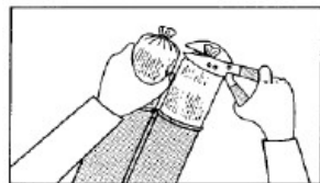
図 3: EZ-Pak Sausages の取付け方法
