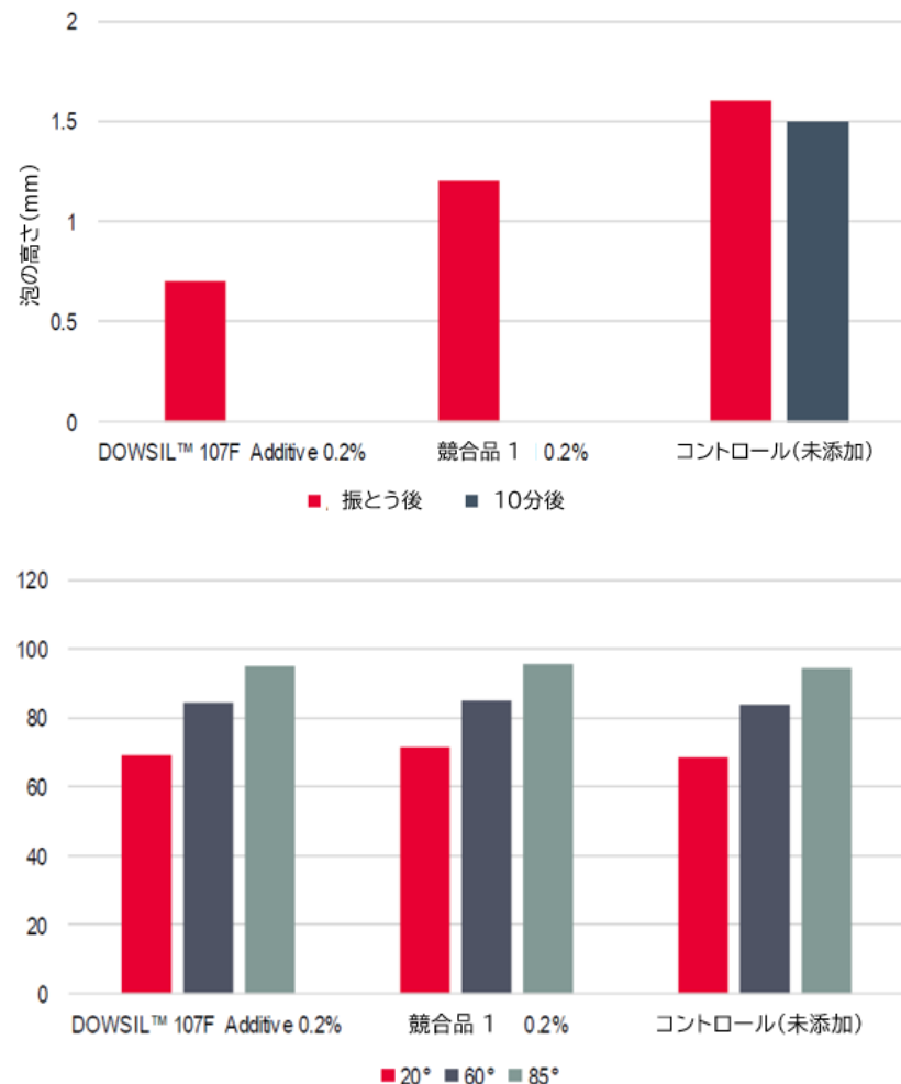
図 1 および図 2. アクリルエマルションベースのクリアウッドコーティング ROSHIELD™ 3188ER に DOWSIL™ 107F Additive と競合品 1 をそれぞれ 0.2wt% 添加し比較しました。評価結果では、DOWSIL™ 107F Additive は、競合品 1 よりも優れた初期消泡性を示しています。また、DOWSIL™ 107F Additive を添加しても塗膜欠陥やグロスの低下は見られませんでした。
