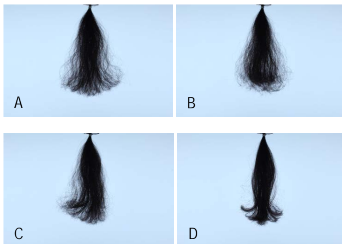
Figura 1: Control De Frizz Al 80% De Humedad Relativa, 25°C Diferencia significativa (99,9% de confianza) entre DOWSIL CB-3046 Fluid al 15% y los otros tres productos.
