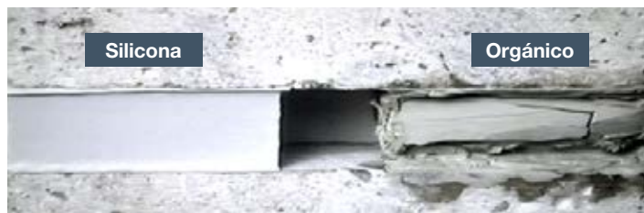
Resultado de 2500 horas de exposición a radiación ultravioleta en laboratorio de un sellador de silicona y un sellador orgánico (poliuretano)
