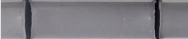
写真2 シリコーン系シーリング材の伸長圧縮繰り返し後の状態 剥離・亀裂は全く見られない
