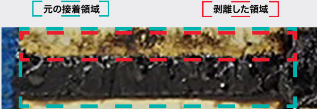
写真1 ポリブタジエン系シーリング材の剥離状態 シーリング材全長(50 mm)にわたって剥離
