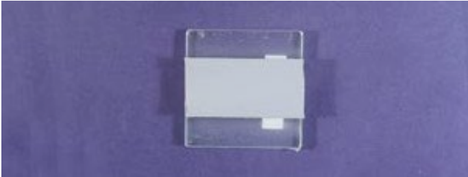
ひび割れ等は認められなかった DOWSIL™ SE 980 Aはシリコンシーリング材のため耐候性が良い
