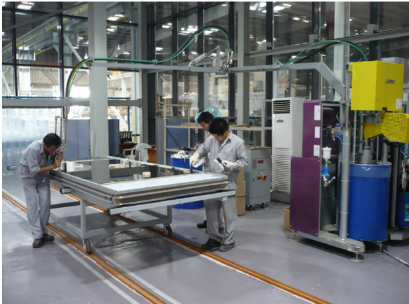
圖2：雙液型密封膠（即陶熙™（DOWSIL™）983或陶熙™（DOWSIL™）993N）需要專用的注膠設備以便在使用前充分混合材料。其應用通常局限於工廠應用環境。
