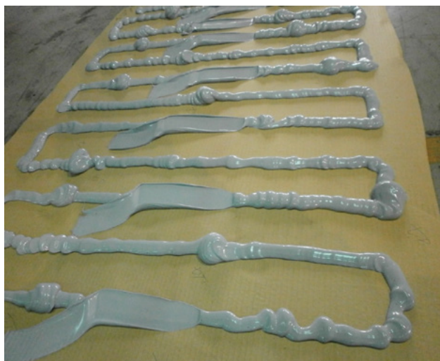
連續擠出測試用於幫助確定打膠機混合品質是否始終良好
