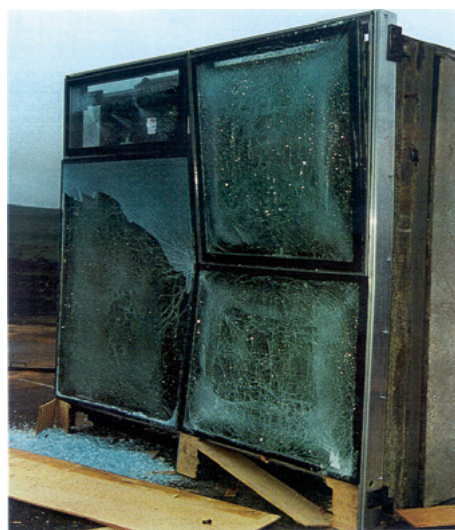
英國經過爆破爆炸測試後的玻璃單元
