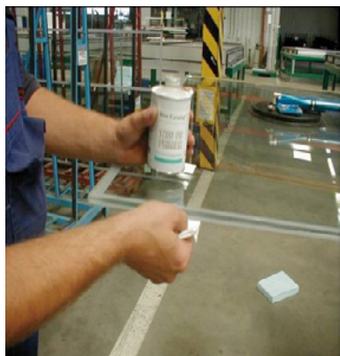
圖5：陶熙™ (DOWSIL™) 1200 OS建築用密封膠底漆或陶熙™ (DOWSIL™) C OS建築用密封膠底漆透過用布在基材上擦拭進行塗敷。可幫助品檢員目視檢查是否正確塗敷UV示蹤底漆的適當紫外線燈。
