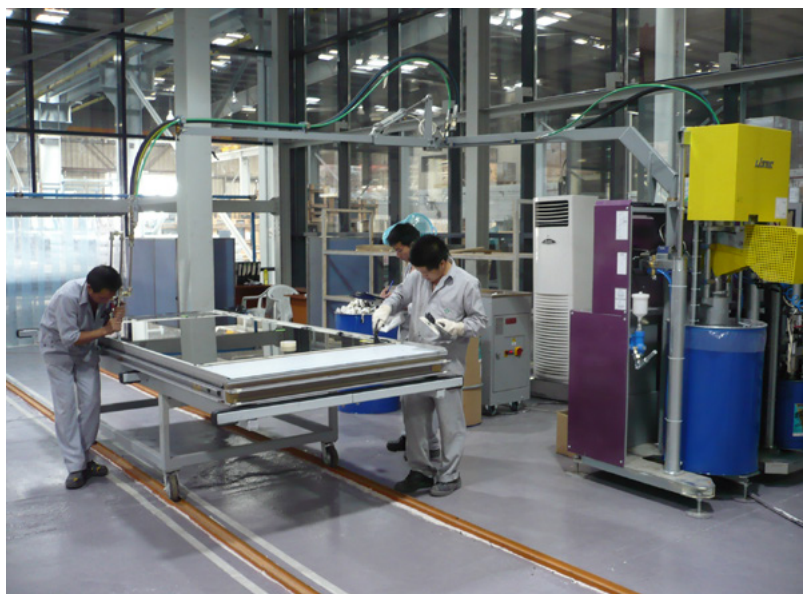
图2：双组分密封胶（即DOWSIL™ 983或DOWSIL™ 993N）需要专用的注胶设备以便在使用前充分混合材料。其应用通常局限于工厂应用环境。
