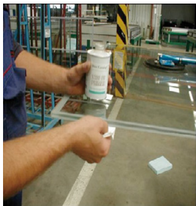
图5：DOWSIL™ 1200 OS建筑用密封胶底涂液或DOWSIL™ C OS建筑用密封胶底涂液通过用布在基材上擦拭进行涂敷。可帮助质检员目视检查是否正确涂敷UV示踪底漆的适当紫外线灯。
