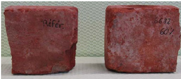
Abbildung 7: Bilder mit Foto- und Infrarotkamera von Ziegeln, die mit 60%-iger (oben rechts) oder 7.5%-iger (unten rechts) Silanemulsion behandelt wurden. Aufnahmen nach Wässerung, um den Kapillaranstieg zu ermöglichen und Lagerung über einige Stunden bei Zimmertemperatur. In der linken Bildhälfte sind die unbehandelten Proben zu erkennen.
