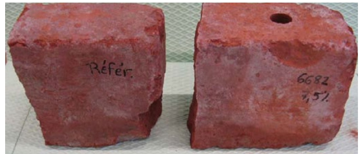
Abbildung 7: Bilder mit Foto- und Infrarotkamera von Ziegeln, die mit 60%-iger (oben rechts) oder 7.5%-iger (unten rechts) Silanemulsion behandelt wurden. Aufnahmen nach Wässerung, um den Kapillaranstieg zu ermöglichen und Lagerung über einige Stunden bei Zimmertemperatur. In der linken Bildhälfte sind die unbehandelten Proben zu erkennen.
