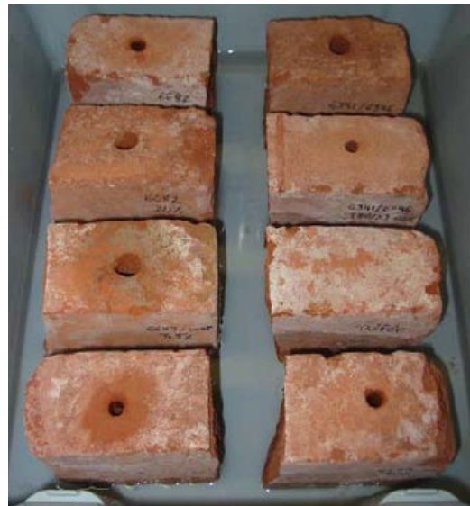
Abbildung 6: Wasseraufnahme von Tonziegeln, injiziert wurde DOWSIL™ IE 6682 Emulsion, als 60%-ige und 7.5%-ige Silanemulsion. Das Foto zeigt die Versuchsanordnung zur Bestimmung der Wasseraufnahme durch Kapillaranstieg.
