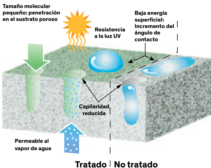
Figura 2. Los productos basados en Silicona penetran profundamente, formando una capa repelente dentro del sustrato
