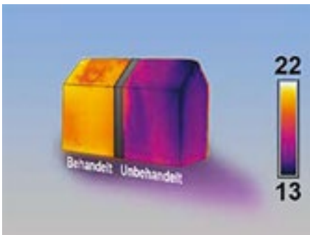
Der Wärmeverlust durch Verdampfen von behandelten, trockenen Untergründen im Vergleich zu unbehandelten, feuchten Untergründen lässt sich mit einer Infrarotkamera sehr anschaulich darstellen.
