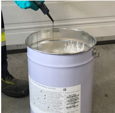
Rys. 8: Dodawanie pasty barwiącej do wiadra ze składnikiem A
