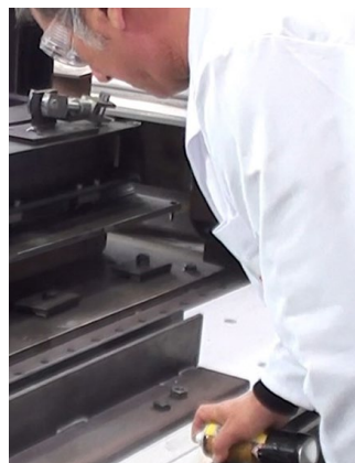
Rys. 4: Natrysnąć środek antyadhezyjny na powierzchni profilu U
