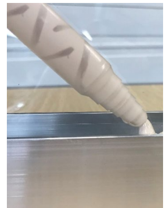
Rys. 11: Wtryskiwanie zmieszanych składników A i B do profilu U
