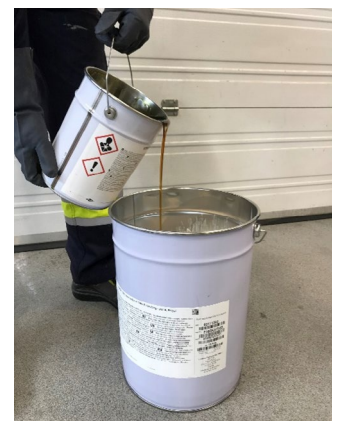
Rys. 12: Wlać składnik B utwardzacz do wiadra ze składnikiem A
