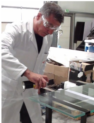
Rys. 3: Natrysnąć środek antyadhezyjny na powierzchni tafli szkła
