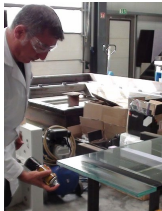
Rys. 3: Natrysnąć środek antyadhezyjny na powierzchni tafli szkła
