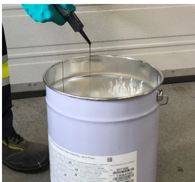
Figura 8: Añada la pasta de color al cubo
