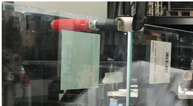
Figura 6: Conecte los paneles adyacentes mediante el uso de un sargento (herramienta)
