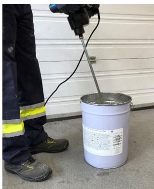
Figura 10: Mezcla del contenido del cubo de la parte A
