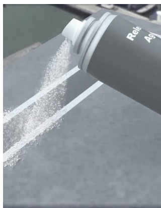
Figura 4: Aplique agente desmoldante en spray en las superficies del perfil en U
