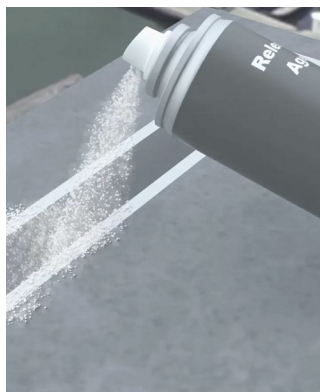
Figura 4: Spruzzare l'agente distaccante sulle superfici del profilo a U
