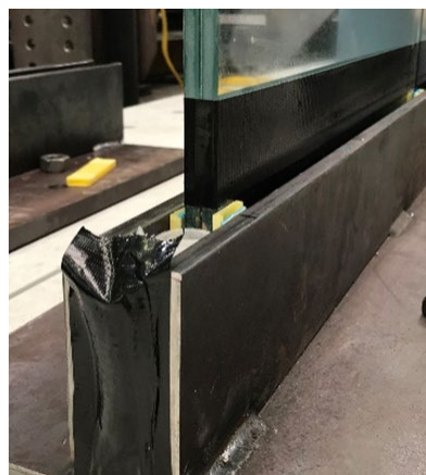
Figura 7: Chiudere le estremità del profilo a U e regolare la posizione con i blocchi di fissaggio
