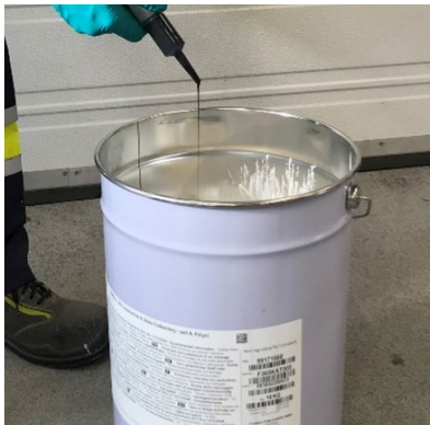
Figura 8: Aggiungere pasta colorata nel secchio della parte
