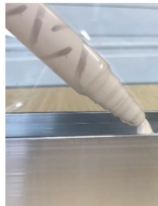
Figura 11: Iniettare parte A e parte B miscelate nel profilo a U
