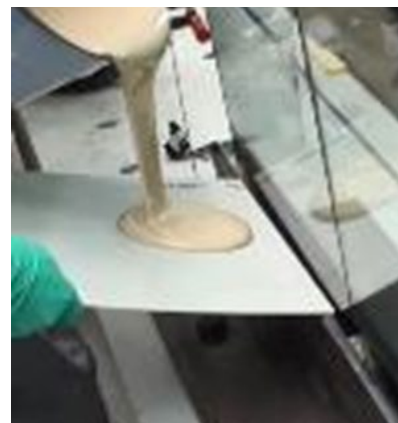
Abbildung 13: Vergussmasse mit Hilfe einer Einfüllhilfe in U-Profil füllen
