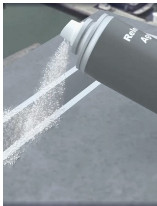
Abbildung 4: Trennmittel auf U-Profil sprühen
