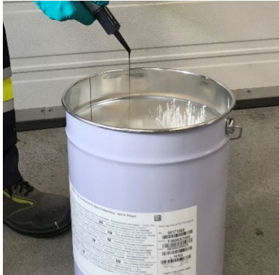
Abbildung 8: Farbpaste dem Eimer von Komponente A hinzufügen
