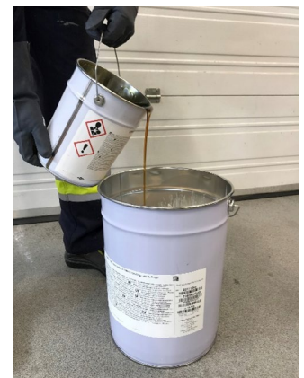
Abbildung 12: Komponente B (Härter) in den Eimer von Komponente A gießen
