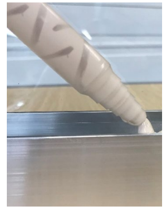
Abbildung 11: Vergussmasse (Komponente A und B vermischt) in das U-Profil füllen
