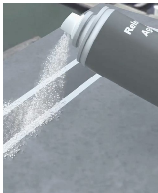
Figure 4: Pulvérisez l'agent de démoulage sur les surfaces du profilé en U
