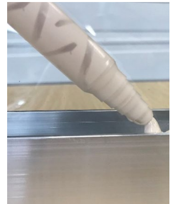
Figure 11: Injection du mélange des composants A et B dans le profilé en U
