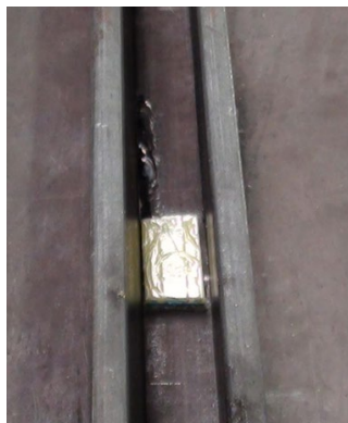
Figure 5: Placez des cales au fond du profilé en U
