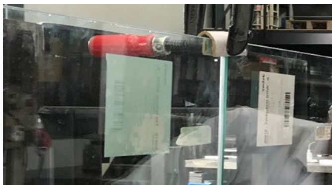
Figure 6: Joignez les panneaux adjacents à l'aide de serre-joints
