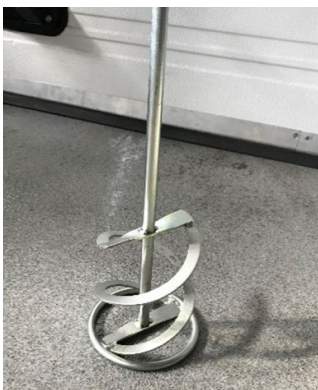
Figure 9: Agitateur de mélange
