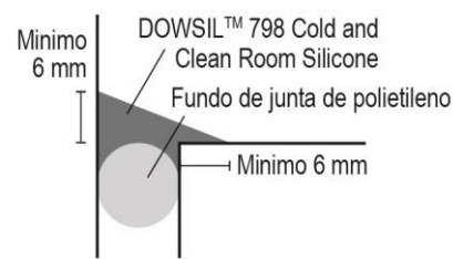
Figura 3: Junta de filete.
