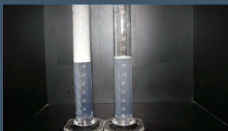
La imagen muestra el tubo de ensayo en presencia de surfactante. El recipiente de la izquierda presenta una solución con 1% surfactante, mientras que el de la derecha muestra el efecto del colapso de la espuma con la adición de 60 ppm de antiespumante Dow en la misma solución.
