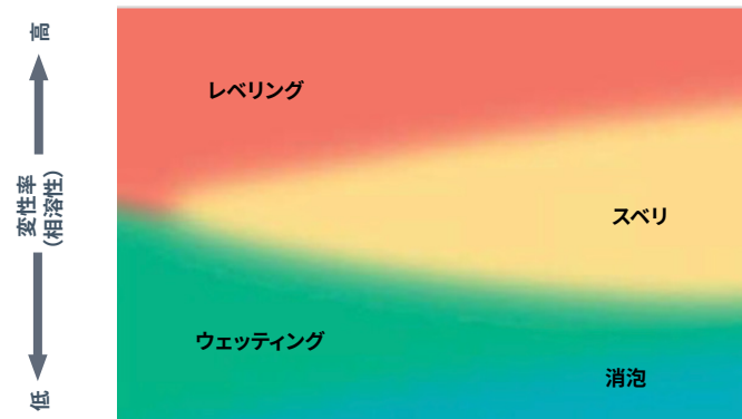
図10 シリコンの構造と機能の関係（水系塗料）
