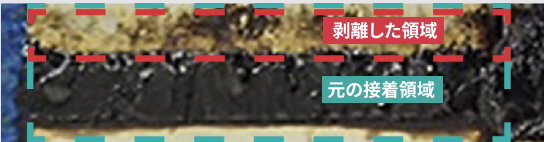
(写真2) シリコン系シーリング材の伸長圧縮繰り返し後の状態 剥離・亀裂は全く見られない
