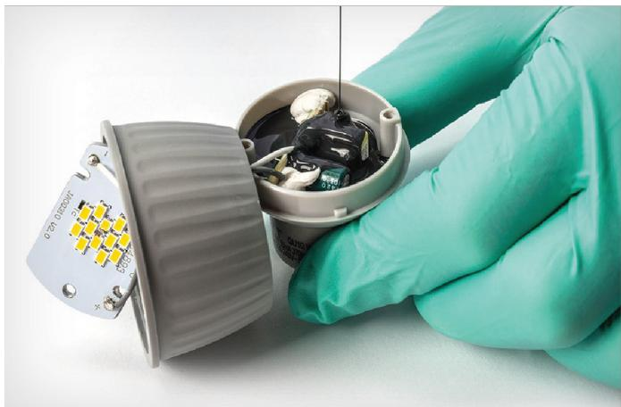
La contaminación ambiental y el daño térmico a los componentes pueden ser dos de las mayores amenazas a la confiabilidad de su iluminación LED a lo largo de la vida útil de la misma. Las siliconas para pottants térmicos DOWSIL™ y SYLGARD™ protegen los conductores LED de la humedad y del polvo, al tiempo que disipan el calor y absorben los ruidos del componente.
