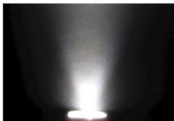
新设计 (SILASTIC™ MS-1002 可塑硅胶) 光滑平直光束
