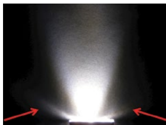
传统设计 (PMMA) 周边的杂散光
