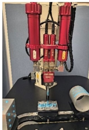
ギャップフィラーなどの2液混合吐出装置TSP500 日本ソセー工業株式会社様 ご提供
